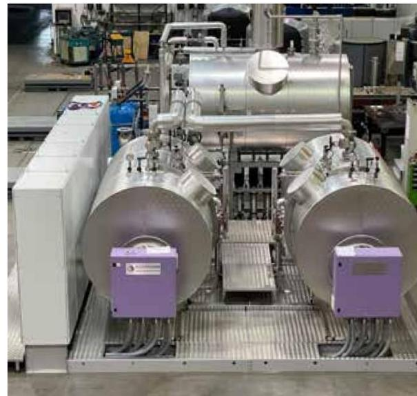
2 calderas de vapor eléctricas con una potencia eléctrica de 1344 kW cada una de ellas montadas sobre SKIDS con un depósito de agua de alimentación (4000 L), un sistema de purga, un distribuidor de vapor, un armario de control (8 m de longitud), un sistema de ósmosis inversa con 3 depósitos de almacenamiento de 4000 L, tuberías completas y cableado.
